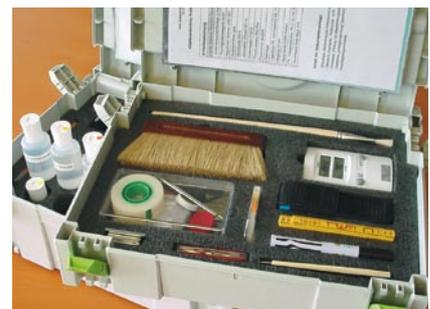
Mit einem Prüfset lässt sich ein Gipsuntergrund oder eine Altbeschichtung einfach auf seine bzw. ihre Tragfähigkeit prüfen.
