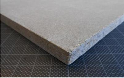
Duripanel ist eine zementgebundene Spanplatte. Sie besteht aus ca. 52 Vol. % Holzspänen und ca. 39 Vol. % mineralischen Bindemitteln (hauptsächlich Zement) und 9% Wasser. Durch die Imprägnierung mit Mineralsalzen und die Ummantelung mit Zement werden die Holzspäne widerstandsfähig gegen Pilz- und Termitenbefall, Verrottung und Feuer.
