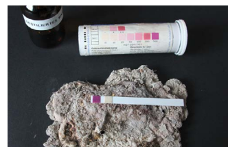
Analyse bauschädliche Salze
