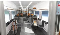
Images: à l'intérieur, les peintures en poudre de la société KABE Farben répondent aux prescriptions de protection incendie et protégé contre le transfert de bactéries grâce à un revêtement spécial.
