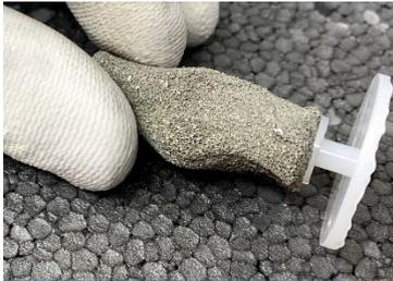
3. Comprimer la mousse souple imprégnée au niveau du CEP à moins de 18 mm en la roulant et en la pressant à la main
