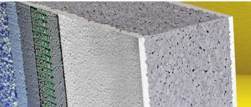
Le panneau isolant à 3 couches pour façades composé de 95% de PSE gris et 5% de PSE blanc, comme couche de réflexion. Le panneau isolant pour les façades compactes avec de hautes exigences en matière de planéité de surfaces de panneaux, respectivement de crépi.
