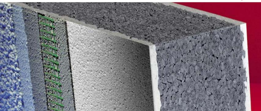
Le panneau isolant PSE est constitué à presque 100% de PSE gris foncé (mousse rigide PS hautement chargée de poudre de graphite) et de deux couches de seulement 3 mm d'épaisseur en PSE blanc hautement réfléchissant.
