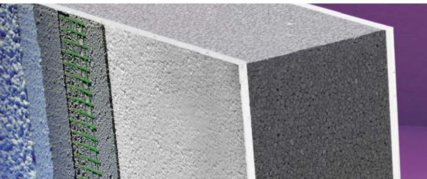
Le panneau isolant est composé d'un panneau central gris (avec absorbeurs d'infrarouge spéciaux) et de deux panneaux de recouvrement PSE blancs (5 mm PSE 20 de chaque côté). Toutes les faces sont fraisées avec précision. La surface blanche permet d'obtenir une haute stabilité de forme. Une simplicité optimale de pose est garantie.
