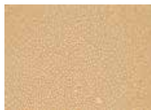
Standard-Pulverlack mit Entgasungsadditiv, von Hand eingerührt, 6,5-fach vergrößert
