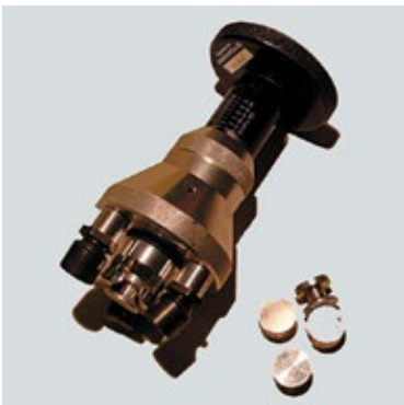
6.5 Haftfestigkeit gemäss SN EN 1542 Prüfgerät
