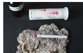
Analyse bauschädliche Salze
