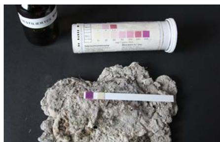
Analyse des sels nuisibles à la construction
