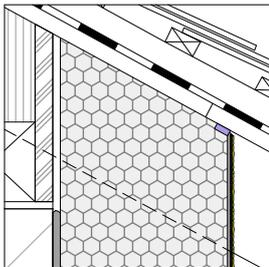
1.651 bis 1.659 Spengleranschluss an Schrägdach
