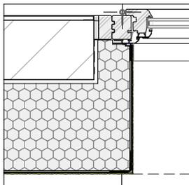
1.511 bis 1.519 Vollsturz mit Wärmedämmung
