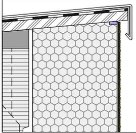
1.621 bis 1.629 Anschluss an Schrägdach
