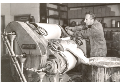
Ein Mitarbeiter bei der Herstellung von Farbpasten an einem Dreiwälzwerk – ein eindrucksvoller Einblick in die handwerklich geprägte Farbenproduktion der frühen Jahre
