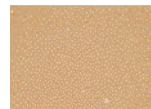
Standard-Pulverlack mit Entgasungsadditiv, von Hand eingerührt, 6,5-fach vergrössert
