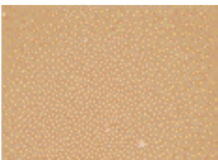
Peinture en poudre standard avec additif de dégazage, mélangée à la main , grossissement 6,5 fois
