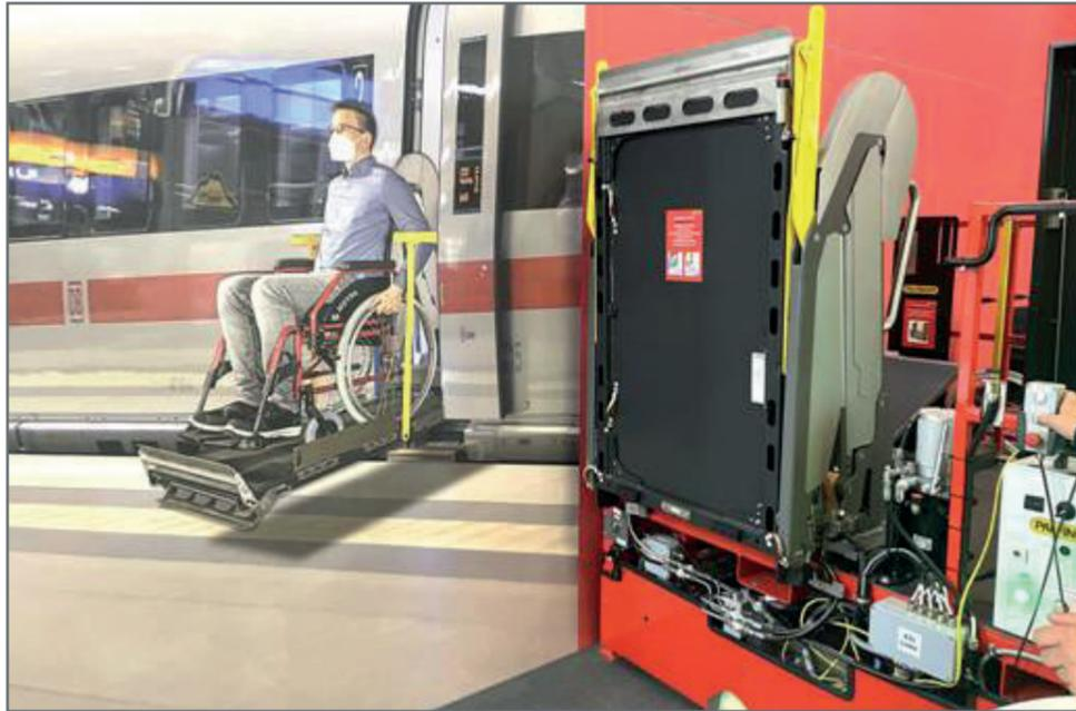
Le Trainlift TRV 2 a été spécialement conçu pour répondre aux exigences du constructeur de trains et a été installé dans une porte spéciale du nouvel ICE. Lorsqu'il est replié, il est très peu encombrant (à droite). Source : © PALFINGER Tail Lifts
