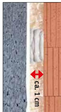
Ca. 3 cm hohe HIGH TACK 1K-Hybrid-Klebstoff Aufhäufungen dienen als Versetzhilfe. Die Platte mit einem Abstand von ca. 1 cm montieren.
