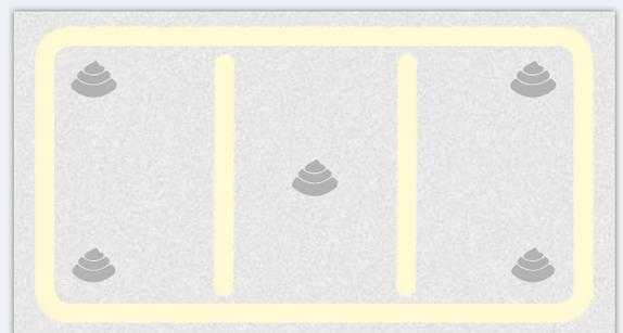
4. Ca. 2 – 3 Minuten nach Auftrag des Schaumes, die Isolationsplatte auf die Wand anbringen und mit der Wasserwaage in die gewünschte Position bringen. Die Dämmplatte ist auf einen festen Fusspunkt aufzusetzen.
